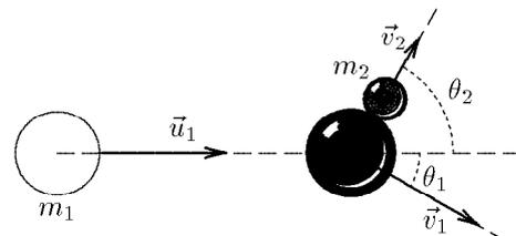
Figure 7.2 L'objet 1 percute l'objet 2 à l'arrêt. Dans ce choc non-central chaque objet part dans une direction différente.
