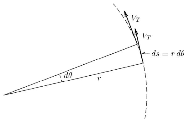
Figure 2.3 Pendant l'intervalle de temps  $dt$ , l'objet parcourt une longueur d'arc de cercle  $ds = r d\theta$ .
