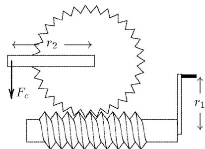
Figure 5.12 Vis sans fin. Quand la manivelle fait un tour la roue dentée tourne d’une dent.
