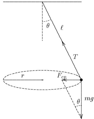
Figure 4.7 Pendule conique. La ficelle décrit un cône et le poids décrit un cercle. La composante horizontale de  $T$  est la force centripète. La composante verticale est égale au poids de l'objet.
