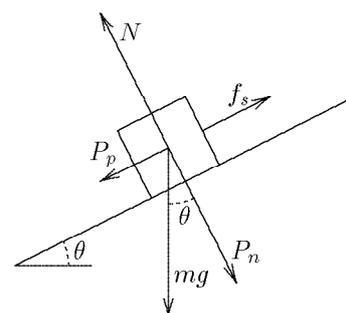
Figure 4.4 L'objet décroche quand la force de friction  $f_s$  ne compense plus la composante du poids parallèle à la surface.
