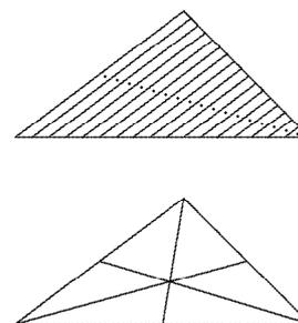
Figure 6.4 Le centre de masses d'un triangle se trouve à l'intersection des médianes.
