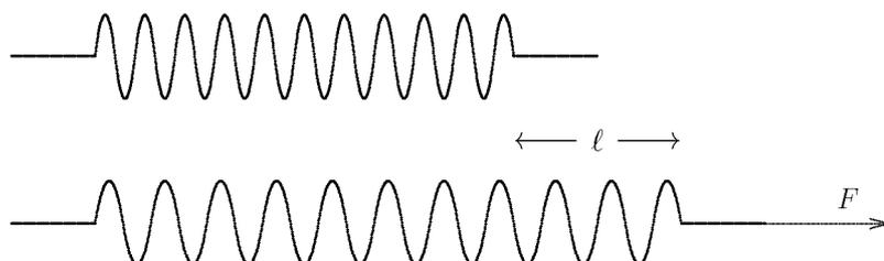
Figure 5.4 La force  $F$  nécessaire pour étirer un ressort est proportionnelle à l'élongation  $\ell$ .
