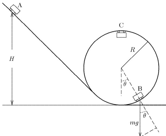
Figure 5.8 Quand le chariot descend, son énergie potentielle se transforme en énergie cinétique. En haut de la boucle (point C) la vitesse est la plus faible. Pour que le chariot ne décroche pas il faut que cette vitesse soit suffisamment élevée.
