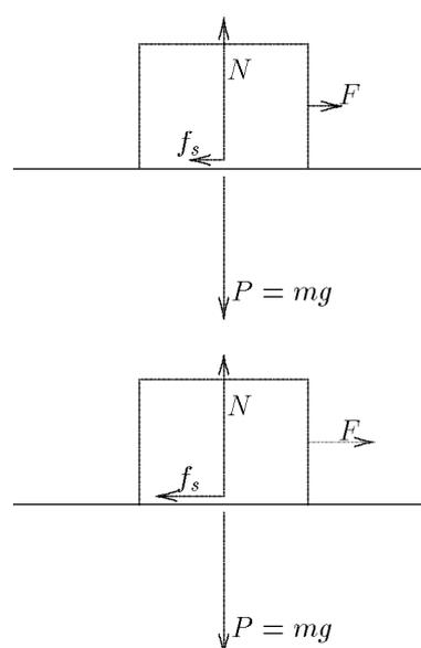
Figure 4.1 La force de friction  $f_s$  compense exactement la force appliquée  $F$  si  $f_s \leq \mu_s N$ .
