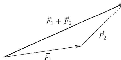
Figure 3.1 Addition géométrique des forces.
