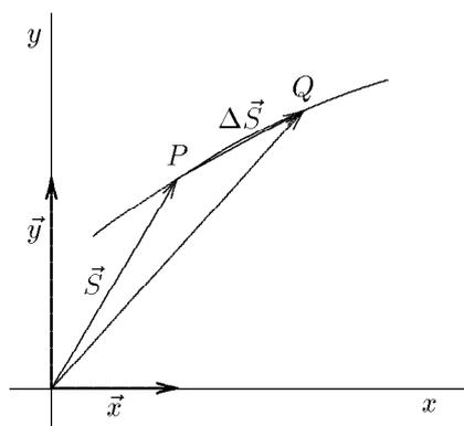
Figure 2.1 La position de l'objet le long de la trajectoire peut être décrite par le vecteur  $\vec{S}$ , et le déplacement entre les points  $P$  et  $Q$ , par le vecteur  $\Delta\vec{S}$ .
