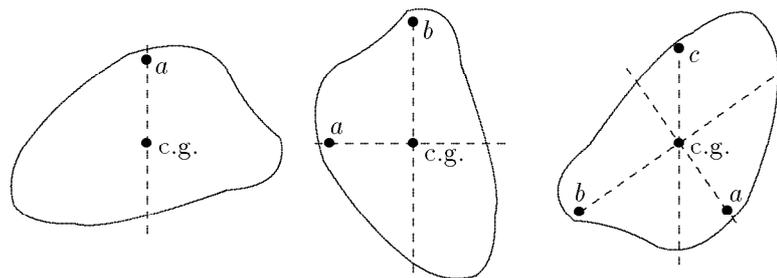
Figure 10.2 Méthode utilisée par les bricoleurs pour trouver, de façon approchée, le centre de gravité d'un objet plat. Elle figure ici pour respecter la tradition.
