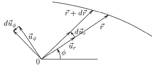
Figure 11.3 Coordonnées polaires. La position d'un point est déterminée par  $r$  et  $\phi$ . Les variations de chaque vecteur unitaire sont parallèles à l'autre vecteur unitaire.
