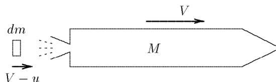
Figure 6.8 Fusée. En réalité  $u$  est beaucoup plus grand que  $V$  et la masse éjectée part vers l'arrière.
