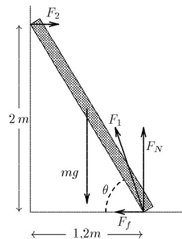
Figure 10.4 Échelle appuyée sur un mur sans friction.
