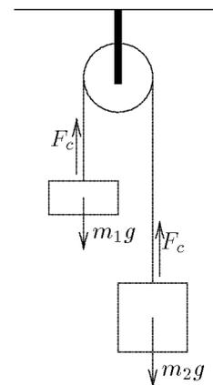
Figure 3.7 Objets accrochés à une poulie. L'objet 2 est plus lourd que l'objet 1 mais sa chute est ralentie par l'objet 1.
