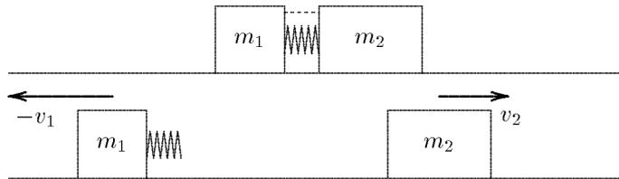
Figure 6.5 Au moment où on coupe la ficelle le ressort pousse chacun des objets avec la même force et dans des directions opposées.
