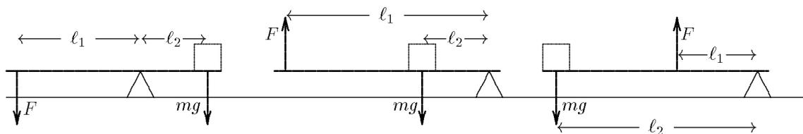
Figure 5.9 Trois configurations de leviers. Celle de droite est peu utilisée: au lieu de démultiplier la force, elle l'augmente.
