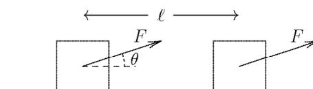
Figure 5.2 Le travail est égal au produit de la composante de la force parallèle au déplacement multipliée par ce dernier.  $T = F \ell \cos \theta$ .
