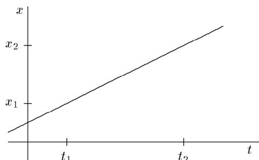
Figure 1.2 Quand la vitesse est constante, l'espace parcouru augmente (ou décroît) linéairement avec le temps. La pente de la droite est égale à la vitesse.
