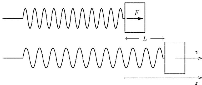
Figure 5.6 En haut le ressort est comprimé d'une longueur  $L$ . En bas il s'est détendu en poussant l'objet. La force diminue à mesure que le ressort se détend.
