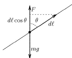
Figure 5.3 Le travail à fournir pour soulever un poids ne dépend que de la distance verticale.
