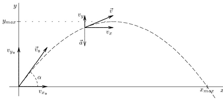
Figure 2.2 Trajectoire d'un projectile. La vitesse horizontale ne change pas. Par contre la vitesse verticale diminue puis s'inverse. L'accélération  $\vec{a}$  est constante et toujours dirigée vers le bas.
