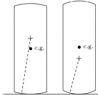
Figure 10.9 L'objet de gauche est en équilibre stable. Celui de droite est en équilibre instable.
