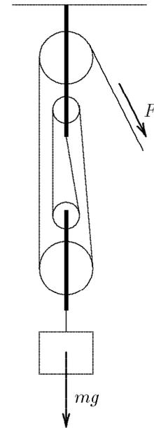
Figure 5.11 Palan composé de deux poulies doubles. La force est diminuée d’un facteur 4.
