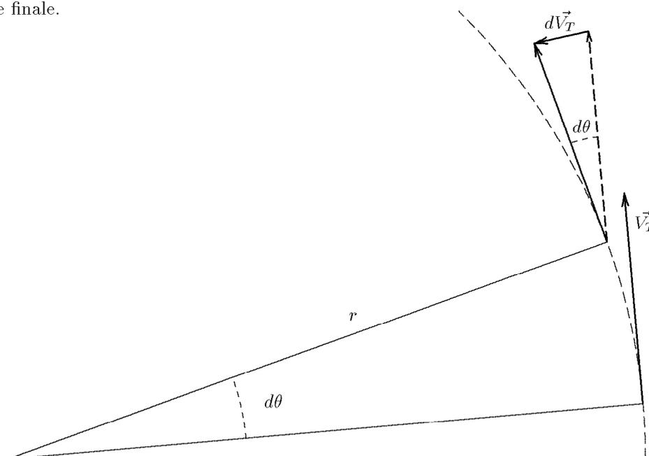
Figure 2.4 Pendant l'intervalle de temps  $dt$ , la direction de la vitesse a changée d'un angle  $d\theta$ . Cela correspond à un changement de vitesse  $dV_T$ .
