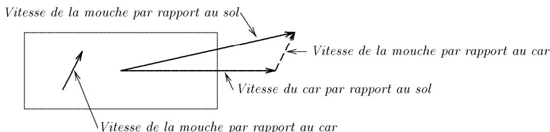
Figure 2.6 La vitesse de la mouche et celle du car s'additionnent vectoriellement.
