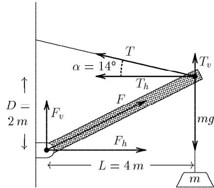
Figure 10.5 Mât de charge. La poutre peut pivoter autour de son support. La tension du câble maintient la poutre en place.
