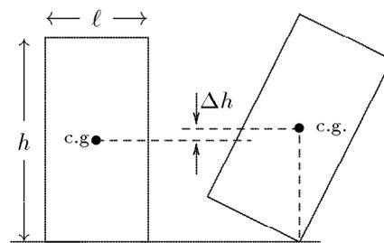
Figure 10.8 L'équilibre est stable jusqu'à la position de droite. L'énergie à fournir est proportionnelle à  $\Delta h$ .
