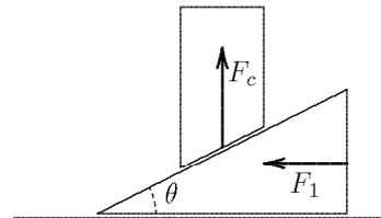
Figure 5.10 Quand on force le coin vers la gauche il soulève la charge. Dans ce dessin on suppose qu'il n'y a pas de friction.
