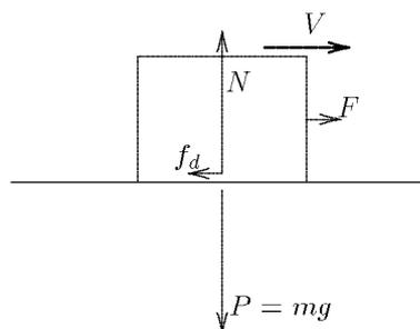
Figure 4.2 La force de friction dynamique  $f_d$  ne dépend pas de la vitesse. Si la force appliquée  $F$  est plus grande que  $f_d$  l'objet est accéléré. Si  $F < f_d$  l'objet est ralenti.
