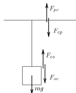
Figure 3.3 Le poids de l'objet est compensé par la force exercée sur lui par la corde. La réaction à cette force est transmise au plafond.
