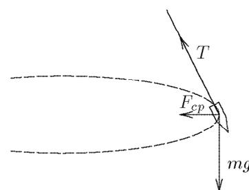
Figure 4.5 Fil à plomb dans une voiture qui suit la trajectoire en pointillés. Forces vues par un observateur au sol. La somme des forces n'est pas zéro et le plomb est accéléré vers l'intérieur de la trajectoire.
