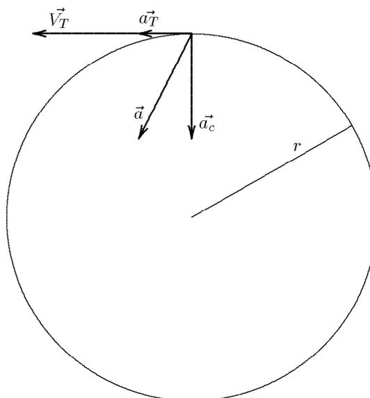
Figure 2.5 Dans un mouvement circulaire non uniforme l'accélération totale est la somme de l'accélération centripète  $a_c = V_T^2/r$  plus une accélération tangentielle  $a_T$ . L'accélération totale  $\vec{a}$  n'est plus dirigée vers le centre de rotation.
