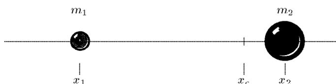
Figure 6.1 Le centre de masses de deux masses se trouve sur la ligne qui les rejoint. La distance à chaque masse est inversement proportionnelle à la masse.
