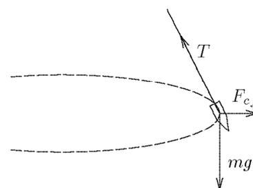
Figure 4.6 Fil à plomb dans une voiture qui suit la trajectoire en pointillés. Forces vues par un observateur dans la voiture. La somme du poids plus la pseudo-force centrifuge s'annulent avec la tension du fil.
