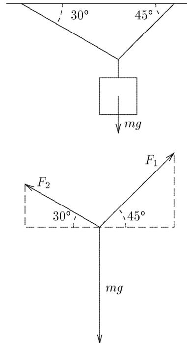
Figure 3.6 Objet accroché à deux ficelles. On connaît l'angle formé par les ficelles. La somme des forces dans toutes les directions doit s'annuler.
