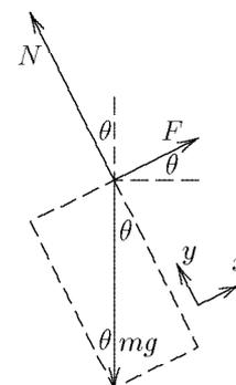
Figure 3.5 Objet tenu immobile sur un plan incliné sans friction. On peut calculer  $F$  et  $N$  en projetant dans un repère horizontal-vertical comme dessiné au milieu. Mais le calcul est immédiat si l'on choisit un repère parallèle-perpendiculaire au plan incliné, comme le dessin d'en bas.
